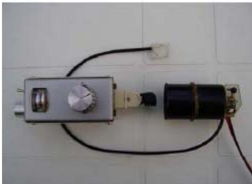
Nella parte alta dell’immagine si può notare una minuscola spira protetta da uno strato di “scotch” che verrà inserita fra le spire della bobina inaccessibile, o in prossimità del circuito sotto esame. All’estrema destra, il circuito amplificatore a larga banda che alimenta l’avvolgimento da accoppiare, a sua volta, alla bobina del G.D.M.
